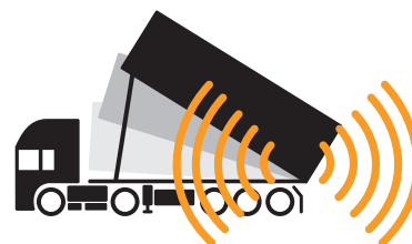
Kierowcy wolno rozpocząć jazdę po upewnieniu się, że skrzynia samowładowcza została opuszczona po rozładunku
