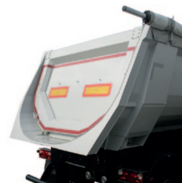
Sprawne elementy blokujące tylną klapę
